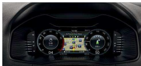
Das **Extended-Layout** liefert eine Hauptanzeige über die gesamte Displaybreite – zum Beispiel das laufende Musikprogramm oder die Navigationskarte. Darunter und darüber bleibt Platz für kleine digitale Anzeigen. Beispielsweise die gefahrene Geschwindigkeit, die Schaltempfehlung, die Verkehrszeichenerkennung, die verbleibende Restfahrstrecke, die Entfernung zum nächsten Abzweig auf der programmierten Route oder
