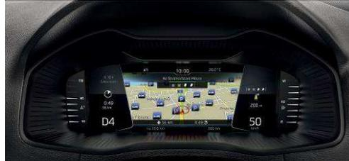
Das **Basic-Layout** zeigt zwei ausgewählte digitale Informationen im Grossformat an, zum Beispiel die gefahrene Geschwindigkeit und die verbleibende Reichweite. Zusätzlich können oben und unten im Display Grundinformationen (Uhrzeit usw.) dargestellt werden. Mit aktivierter Navigations-Zielführung sind in der Mitte auch die Navigationspfeile sichtbar.
